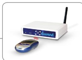
Attivare la trasmissione IR tenendo premuti i due pulsanti freccia fino a quando compaiono due frecce sul display.
