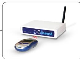
Attivare la trasmissione IR tenendo premuti i due pulsanti superiori del glucometro fino a quando compaiono due frecce sul display.
