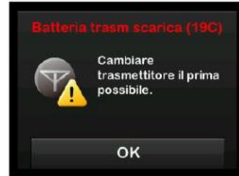
Si è verificato un errore del trasmettitore e la sessione CGM è stata interrotta. Se questo avviso compare nel periodo della garanzia del trasmettitore (entro 90 giorni dalla data di attivazione) contattare l'assistenza tecnica Movi.
